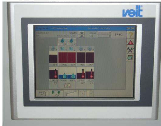
Um Datenverlust bei den Setupeinstellungen, sowie der Datums-, Uhrzeiteinstellungen zu verhindern wird empfohlen, alle 3 Jahre die Pufferbatterie auszutauschen.
