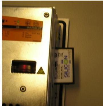
1. Die Compact Flash Karte **des defekten Panels** vorsichtig und seitenkorrekt in das Austauschpanel bis zum Führungsende schieben.
